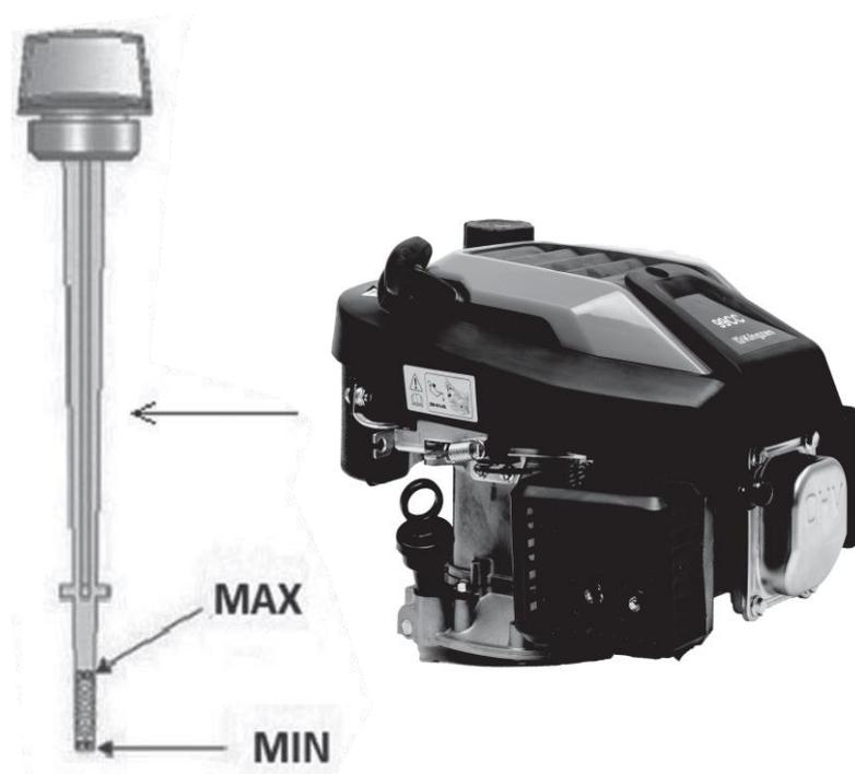
Il tagliaerba viene fornito **senza olio motore**. Precedentemente al primo utilizzo, eseguire il rabbocco con olio SAE30 oppure olio 15W-40 (ca. 600 ml) attenendosi alle istruzioni indicate di seguito:
