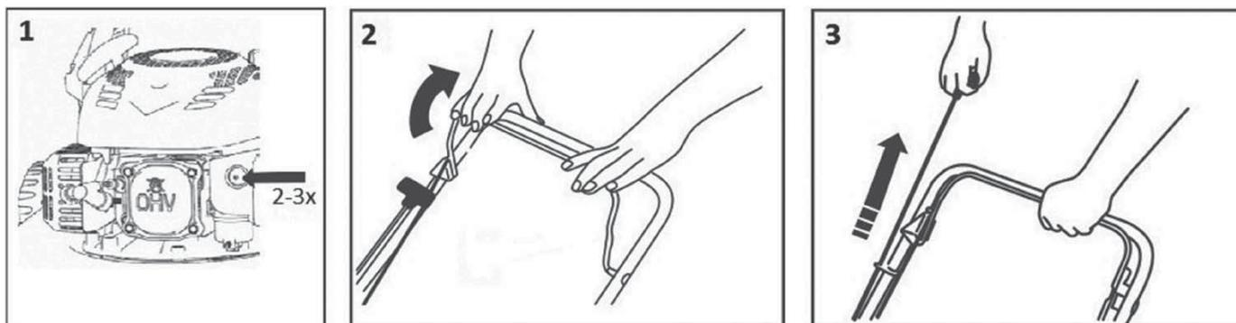
Ziehen Sie den Start-/Bremshebel zum Griff und halten Sie ihn fest, dann ziehen Sie an der Zugschnur. Der Motor sollte nach 3-4 Zügen anspringen. Durch Loslassen des Start-/Bremshebels wird der Motor abgestellt.
