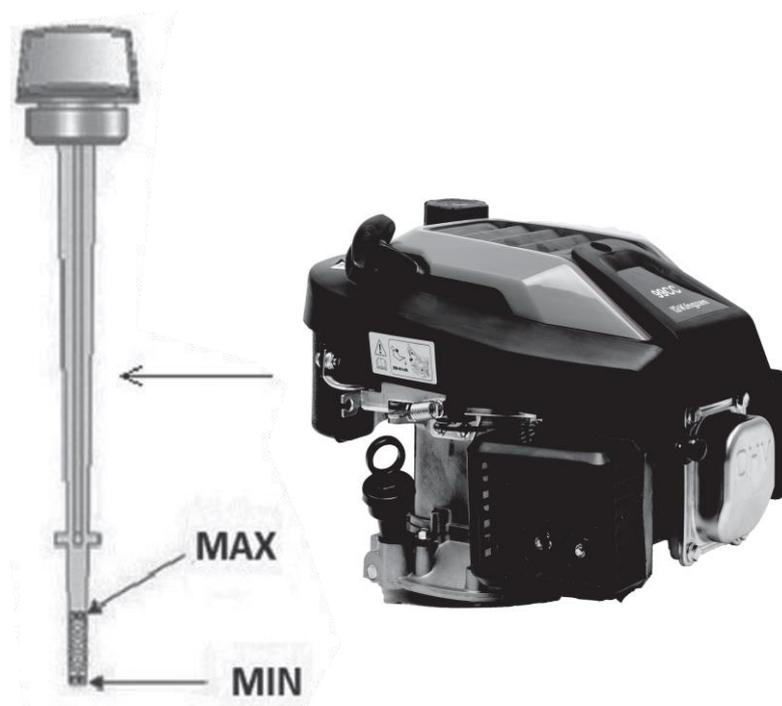
Der Rasenmäher wird **ohne Motoröl** geliefert. Füllen Sie vor der ersten Inbetriebnahme Motoröl SAE30 oder 15W-40 (ca. 600 ml) gemäß den folgenden Anweisungen ein:
