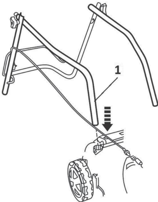
Fixez la partie supérieure de la poignée à la partie inférieure à l'aide des vis fournies avec les molettes à oreilles (voir illustration suivante).
