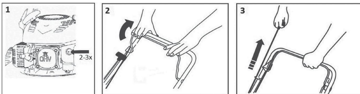
Tirez le levier de démarrage/freinage vers la poignée et tenez-le fermement, puis tirez sur la corde de traction. Le moteur devrait démarrer après 3-4 tractions.
