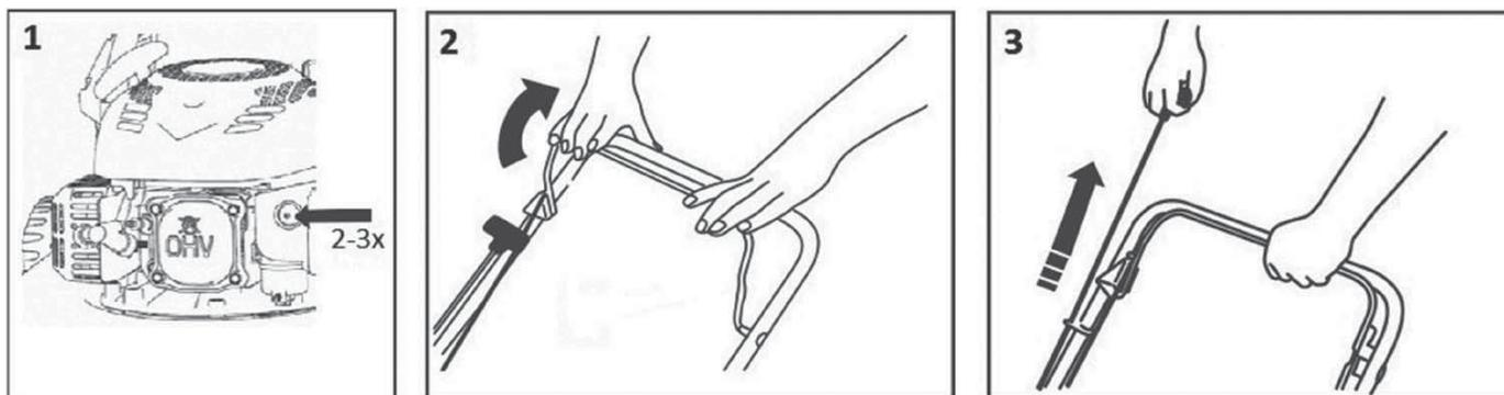
Tirare la leva di avviamento/freno verso l'impugnatura e tenerla premuta, quindi tirare la corda di avviamento. Il motore dovrebbe avviarsi dopo 3-4 trazioni. Rilasciando la leva di avviamento/freno il motore si arresta.
