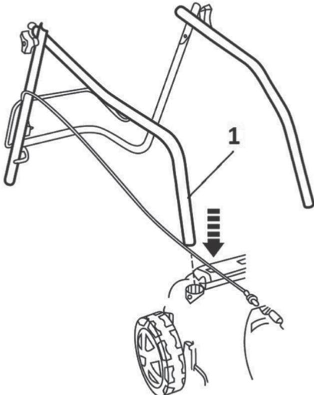
Befestigen Sie den oberen Teil des Griffs mit den mitgelieferten Schrauben mit Flügelmuttern am unteren Teil des Griffs (siehe folgende Abbildung).
