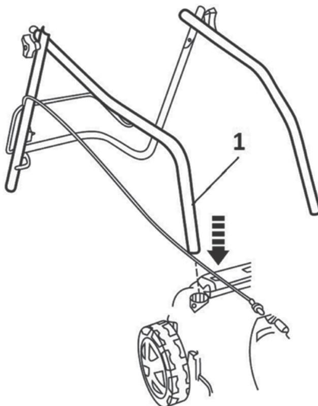
Fije la parte superior de la empuñadura a la parte inferior del manillar utilizando los tornillos y las tuercas de mariposa (véase la imagen inferior).
